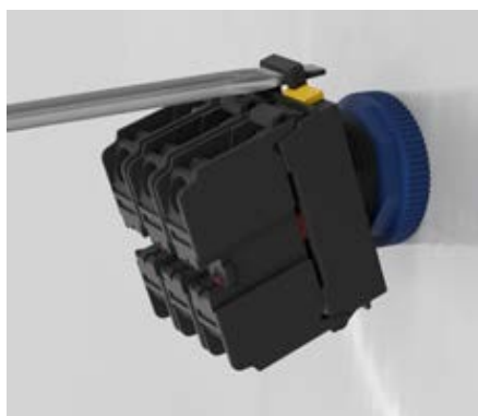
Fig. 6: El portacontactos a presión permite desmontarlo fácilmente con un destornillador gracias a la lengüeta de liberación, fácil de localizar.
